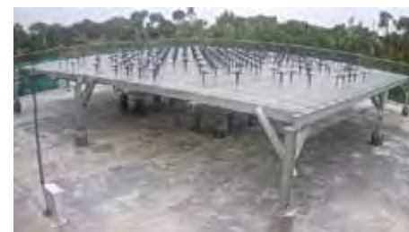
▲協助氣象局為觀測西南氣流、颶風動向及南海海域天氣監測，在東沙島設置剖風儀。
