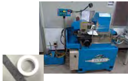
▲經由岩芯研磨機可控制內外徑大小以生成圓環試體。
