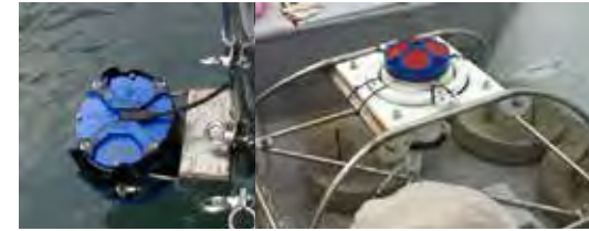
▲船載與底碇 ADCP (Acoustic Doppler Current Profiler)。
