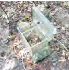
▲圖 12 自製自動式土壤呼吸作用觀測系統。
