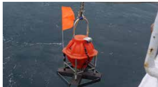
▲圖 21 有別於 MicrOBS，MicrOBS Plus 雖然重量增加，但能夠執行任務時間也比過去更長 (記錄資料加上休眠時間可達一個月)。
