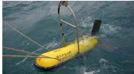
▲圖 20 美國 Edgetech 公司生產的底拖式整合底質剖面側掃聲納 (Side-Scan Sonar combined Sub-bottom Profiler) : 2400-DSS，最深拖曳深度可達 3000 米，並且可以判視海床上小於 2 公分變化的物件。
