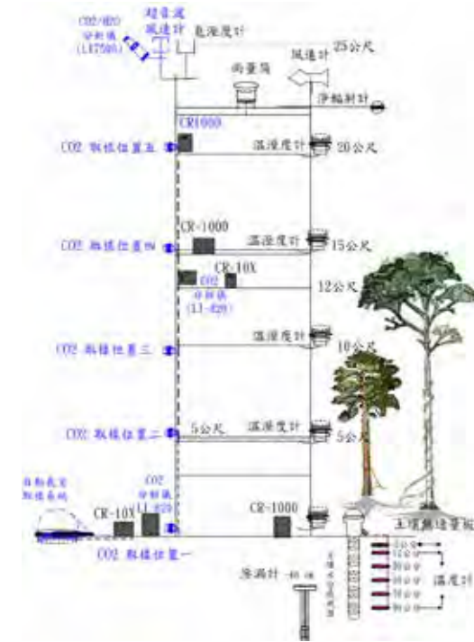
▲圖 13 蓮華池水文微氣象與通量測站儀器配置圖。
